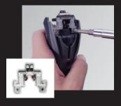
**CÓMO:** Apague la máquina de corte y retire la cuchilla desmontable. Deslice la tapa del sistema de accionamiento para quitarla. Desenrosque los tornillos con un destornillador Phillips y levante el conjunto del sistema de accionamiento. Instale un nuevo sistema de accionamiento y siga los pasos en orden inverso para completar la instalación.
